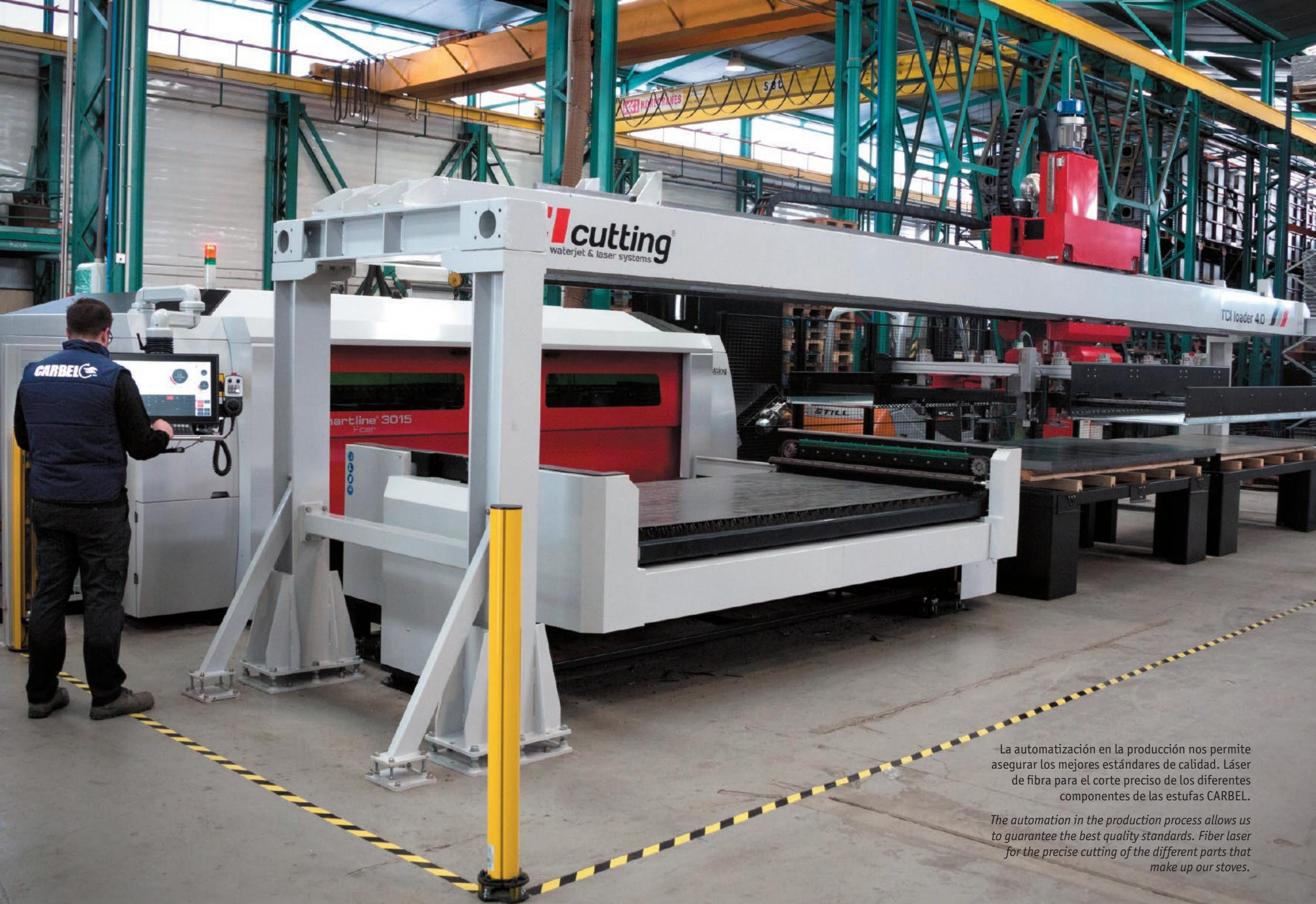
La automatización en la producción nos permite asegurar los mejores estándares de calidad. Láser de fibra para el corte preciso de los diferentes componentes de las estufas CARBEL.
